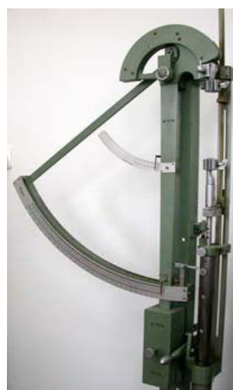
Slika 2. Detalj pričvršćivanja papirne epruvete na aparatu za kidanje papira
