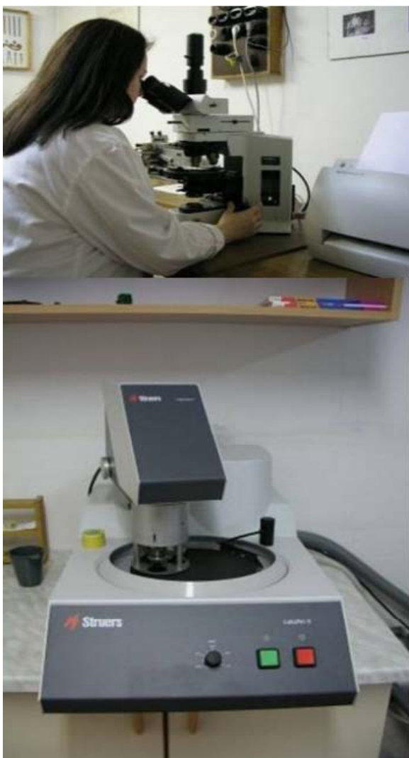
Slika 9. Polarizacijski mikroskop Olympus BX51-P
