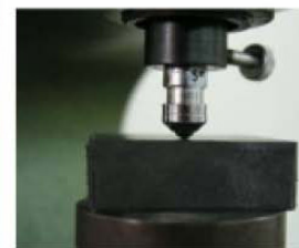
Slika 7. Tvrdomjer s kuglicom za plastomere i duromere
