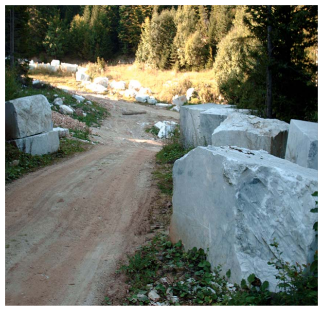
Slika 4. Izrezani blokovi mermera na ležištu Dolovi
